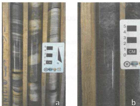
Figura 10: Testemunhos de sondagem (a) BIF e (b) MCH.
